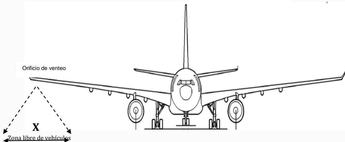
**X**= Varía según el tipo de aeronave y recomendación del fabricante.
